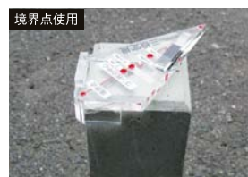
境界点使用 面取り及び欠けで形状が解り難い角ポイント出しに使用。
