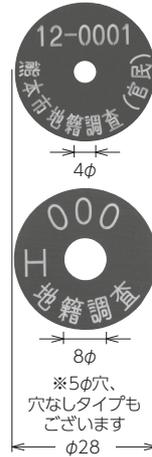
アルミの表面を、アルマイト処理後、文字をレーザー加工しております。(アルマイト処理とは、表面処理を施したもので、アルミ素材そのままよりも、耐久性・耐食性・耐候性・耐摩耗性に優れています。)
